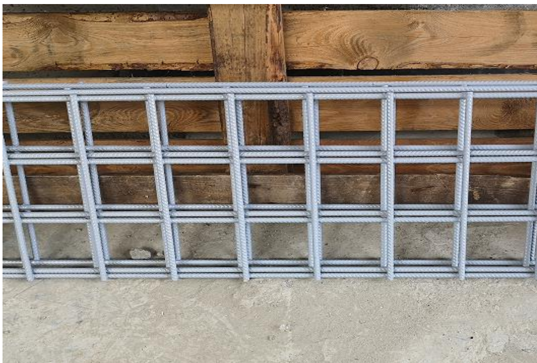
Obr. 11. Pohled na povlakovanou kari síť (PAD) určenou pro realizaci protihlukové stěny nové generace
