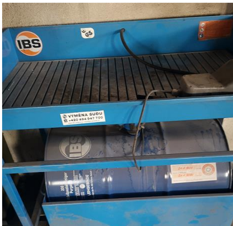
Obr. 8. Odmašťovací zařízení pro předúpravu povrchu
