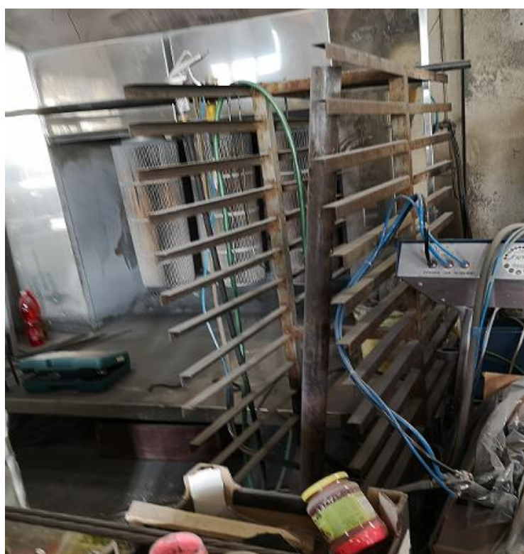
Obr. 9. Zařízení pro nanášení povlaku v elektrostatickém homogenním poli s vyobrazením aplikačních kabin
